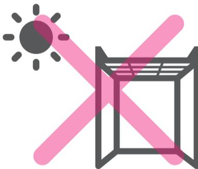
本製品は屋外で野ざらしの保管は控えてください。錆び・腐食などにより耐久性が著しく低下します。また寒暖の変化の激しい場所での使用も耐久性が著しく低下致しますので控えてください。
