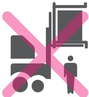
本製品をフォークで持ち上げて段積みする際は、周りに人がいないことを確認し、持ち上げた本製品の下に人が入らないようにしてください。本製品に荷物を積載したままの移動は行わないでください。
