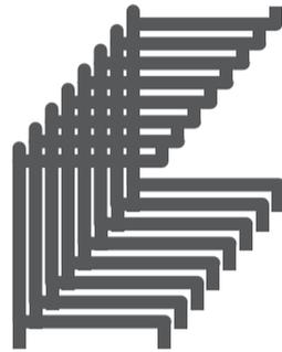
本製品未使用時にネスティングして保管する場合は8段重ねまでとなります。また、重ねたラックの片側はバンドで結束して荷崩れの対策をしてください。
